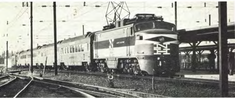
4000 hp Rectifier Electric
