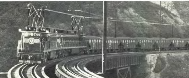
3300 hp Rectifier Electrics
